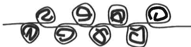
Figura 11 - Diagrama do arranjo do PEDOT:PSS
